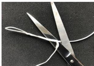
Seil Hülle über das eingeführte Seil ziehen und abschneiden. FERTIG!
